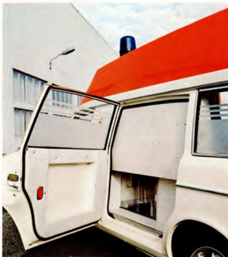
Reservhjulet är placerat bakom höger framstol. Det är mycket lätt att lossa.
