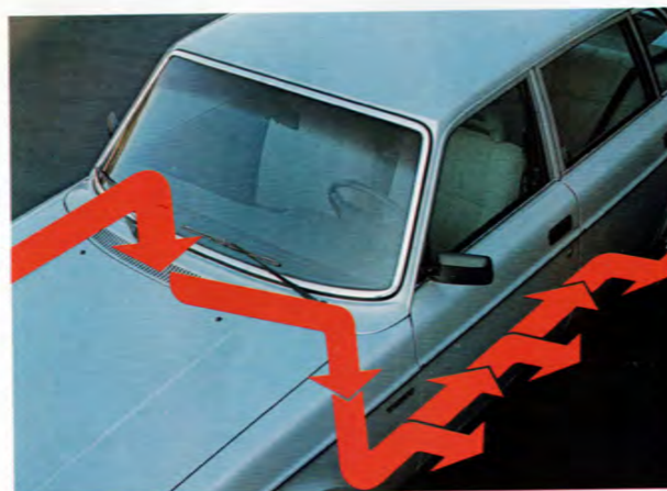
Dörrtrösklarna genomluftas och hålls torra av fartvinden. Dessutom är trösklarna täckta med polyester för att motstå stensprut.
