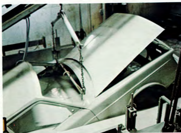
Volvo-karossen får ett effektivt rostskydd. Hela karossen doppas i ett elektrolytiskt grundlackeringsbad, i slutna sektioner används rostskyddsolja. Från midjelisten och nedåt sprutas karossen med stenskottsprimer.
