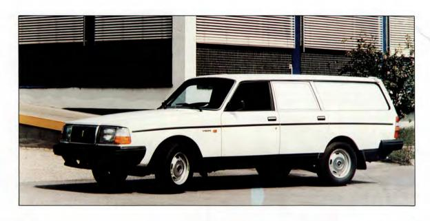
Die besonders große, ebene Ladefläche, die niedrige Ladekante sowie das seitliche Beladen durch die hinteren Türen, erleichtern den Umgang mit sperrigem Ladegut. Volle 2,15 m³ Laderaum stehen zur Verfügung.
