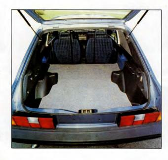
Der komfortable Innenraum im PKW-Styling läßt den Fahrer fast vergessen, daß hinter ihm ein Laderaum von 1,6 Kubikmetern mitfährt. Die Heckklappe schwingt an zwei Gasdrucköffnern weit nach oben, wodurch das Beladen erleichtert wird.
