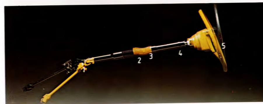
Vid en kollision ger Volvos ratt 5-dubbel säkerhet: 1. Nedre rattaxeln viks 2. Rattstången pressas ihop 3. Rattröret glider framåt-nedåt 4. Rattfästet viker sig 5. Den madrasserade ytan över rattcentrum ger ytterligare skydd
