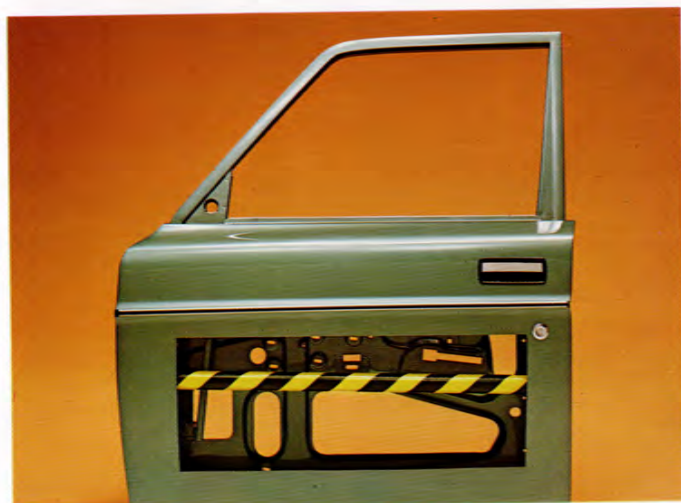
Som skydd vid sidokrockar har Volvo Taxi kraftiga stålrör i alla dörrar, en bred balk svetsad vid golvet och en tvärgående, skyddande plåt vid karossen bakom baksätet.
