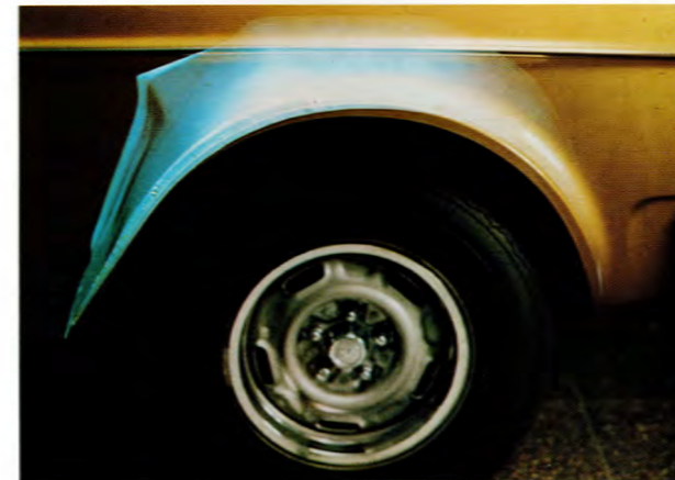
De främre hjulhusen har separata innerskärmar av slagkraftig polypropen som skydd mot stenskott. Det ger lägre ljudnivå och bättre korrosionsskydd.
