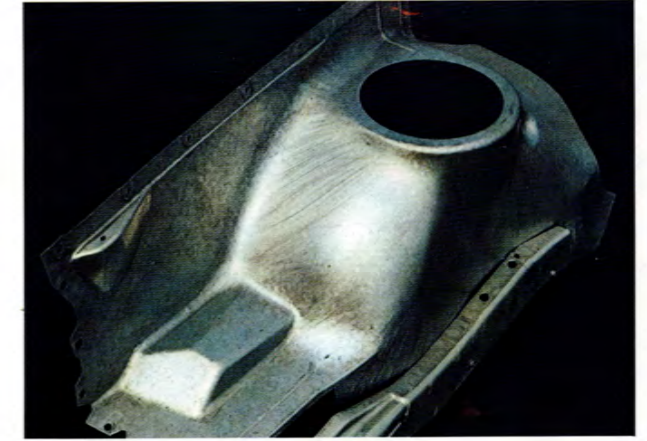
En lång rad karossdetaljer tillverkas av dubbelsidigt varmförzinkad plåt.
