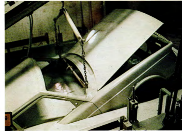
Volvo-karossen får ett effektivt rostskydd. Hela karossen doppas i ett elektrolytiskt grundlackeringsbad, i slutna sektioner används rostskyddsolja. Från midjelisten och nedåt sprutas karossen med stenscottsprimer.
