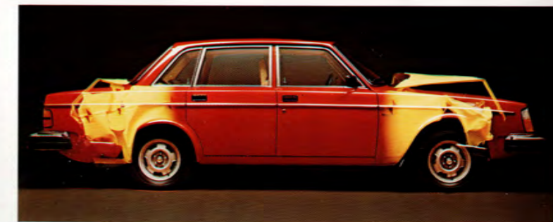
Deformationszoner fram och bak tar upp kraften vid en kollision. Runt passagerarutrymmet sitter Volvos berömda säkerhetsbur av kraftiga stålprofiler. Dörrarna har extra starka stålrör som skydd vid en sidokrock.
