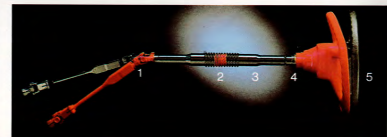
Vid en kollision ger Volvos ratt 5-dubbel säkerhet: 1) Nedre rattaxeln viks. 2) Rattstängeln pressas ihop. 3) Rattroret glider framåt-nedåt. 4) Rattfästet viker sig. 5) Den madrasserade ytan över rattcentrum ger ytterligare skydd.
