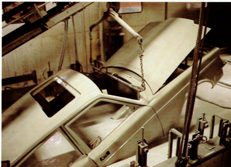
Första steget i antirostbehandlingen är ett dopp i ett elektrokemiskt bad.
