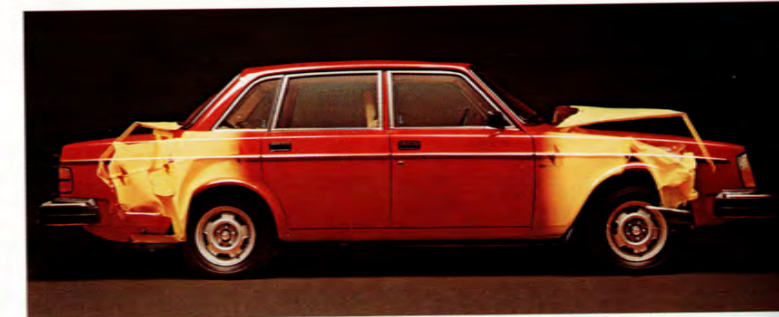
Deformationszoner fram och bak tar upp kraften vid en kollision. Runt passagerarutrymmet sitter Volvos berömda säkerhetsbur av kraftiga stalprofiler. Dörrarna har extra starka stalrör som skydd vid en sidokrock.
