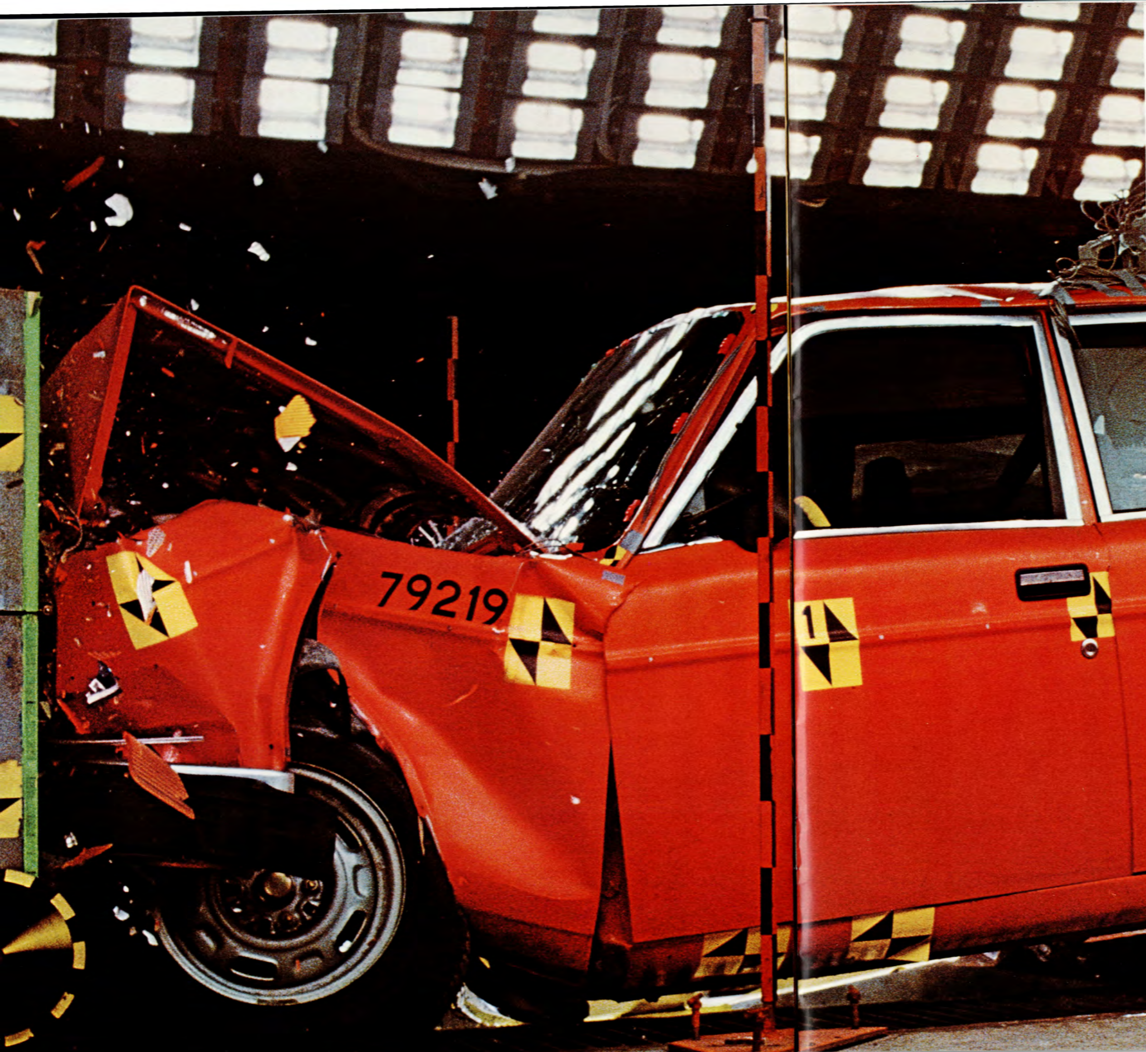
Deformationszoner fram och bak tar upp kraften vid en kollision. Runt passagerarutrymmet sitter Volvos berömda säkerhetsbur av kraftiga stalprofiler. Dörrarna har extra starka stalrör som skydd vid en sidokrock.
