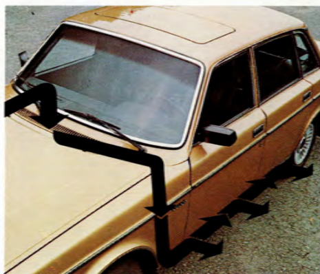
Genomluftning av fartvinden håller Volvos dörrtrösklar torra och fria från rost.
