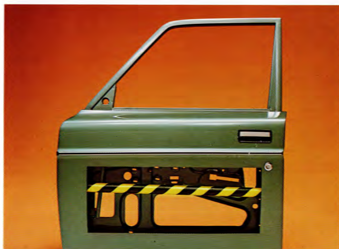
Som skydd vid sidokrockar har Volvo kraftiga stålrör i alla dörrar, en bred balk svetsad vid golvet och en tvärgående, skyddande plåt vid karossen bakom baksätet.
