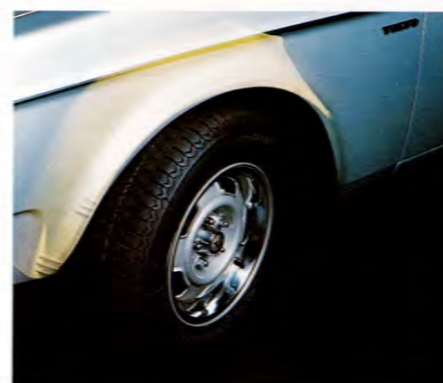
De främre hjulhusen har separata inner-skärmar av polypropen som skydd mot stensprut. Smuts och fukt kan inte stänka upp och ge grogrund för rost.
