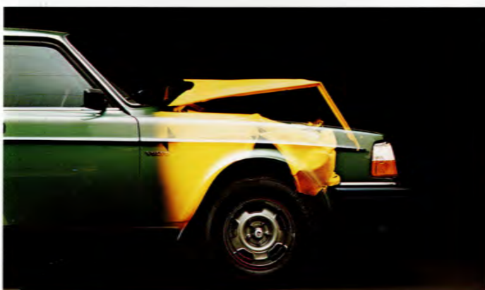
För att skydda förare och passagerare har Volvo deformationszoner fram och bak som fångar upp krafterna vid en eventuell krock.
