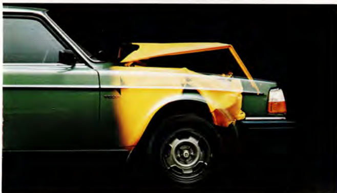
För att skydda förare och passagerare har Volvo deformationszoner fram och bak som fångar upp krafterna vid en eventuell krock.
