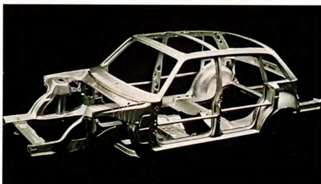
Säkerhetsburen är ett bevis på Volvos ledande roll på krocksäkerhetens område. Alla karossöppningar är omgivna av kraftiga stålprofiler.
