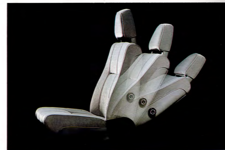
Den berömda Volvo-stolen kan steglöst ställas in till fullt nedfällt läge. Förarstolen är dessutom försedd med termostatreglerad elektrisk uppvärmning.
