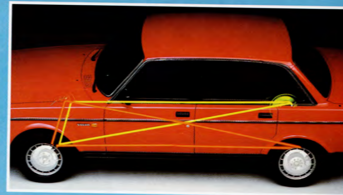
Tvåkrets, triangeldelat skivbromssystem. 80% av bromseffekten kvarstår om en krets skadats.
