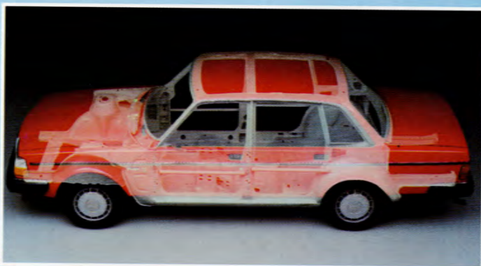
En bur av stål tar vid där deformationszonerna upphör.
