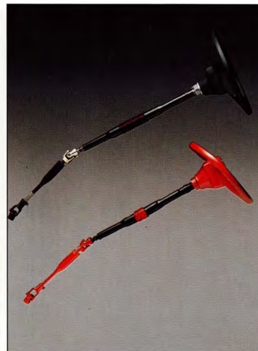
Ratt och rattstång trycks ihop för att inte skada föraren vid kollision.
