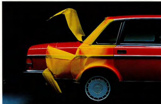
Förutom en stark säkerhetsbur, har Volvo 240 rejäla deformationszoner både fram och bak.
