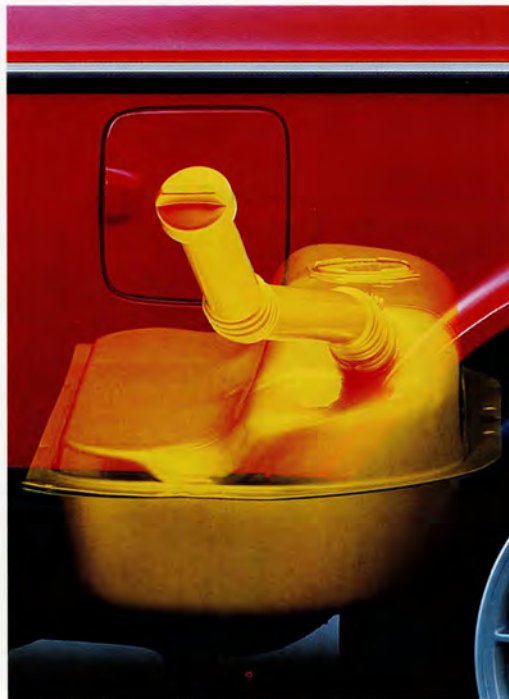
Bensintanken är krocksäkert placerad vid bakaxeln. Dessutom är både påfyllningsrör, tanklock och bensintank konstruerade för att inte läcka vid en kollision.
