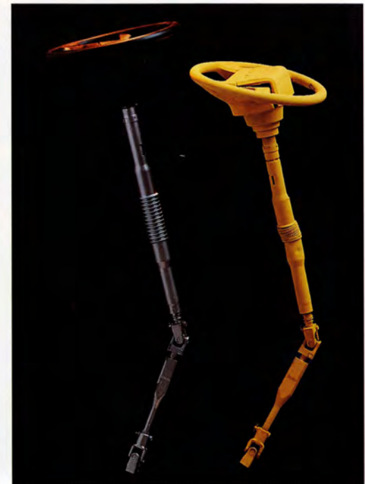
Vid en eventuell kollision viker sig både ratten och rattstäng för att minska risken för skador.
