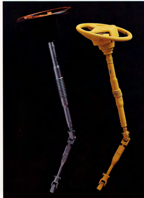
Vid en eventuell kollision viker sig både ratt och rattstäng för att minska risken för skador.
