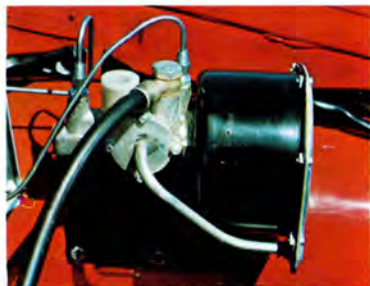
Bromsservo för snabbare säkrare inbromsningar.
