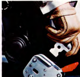
Lättmanövrerad låsanordning för säkerhetsbältena
