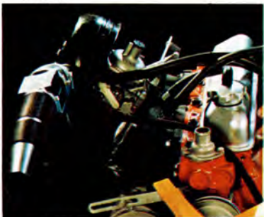
Termostatstyrd luftförvärmning för jämn gång direkt efter start
