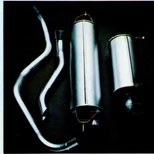
Avgasrör och ljuddämpare är aluminiserade på de utsatta ställena.
