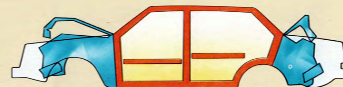
Volvo 264/265 har en kaross som är både mjuk och hård. Fram- och bakparti är mjuka, energiupptagande för att bromsa upp kraften vid en krock. Förare och passagerare är omgivna av en hård, skyddande säkerhetsbur. I dorrarna finns dessutom sidokrockskydd.
