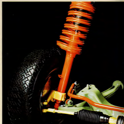
Volvos 260-serie har framvagn med hjulupphängning av fjäderbenstyp. Den gör ojämnheter i vägen mindre kännbara och körningen jämnare och mjukare.
