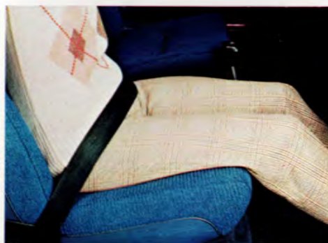
Sätets fram- och bakkant kan höjas och sänkas för att passa just din benlängd och ditt behov av stöd för låren. Till och med fotvinklarna är noggrant uträknade för att minska bentrötthet vid långkörning.
