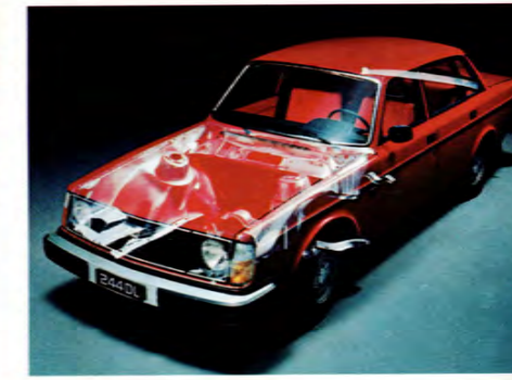
Rost betyder utgifter och kanske en trafik- farlig bil. De mest utsatta karosdelarna hos Volvo 244/245 är varmgalvaniserade med dubbelsidiga zinklager.
