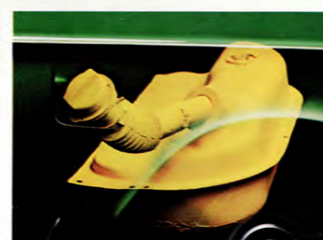
Tanklocket sitter direkt på påfyllningsröret, som är upphängt i en fjädrande gummimanschett. Därigenom minskar risken för bränsleläckage vid t.ex. krock bakifrån.
