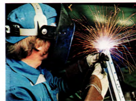
Den starka Volvo-karossen. Var och en av de 7000 svetspunkterna kan bära karossens tyngd.
