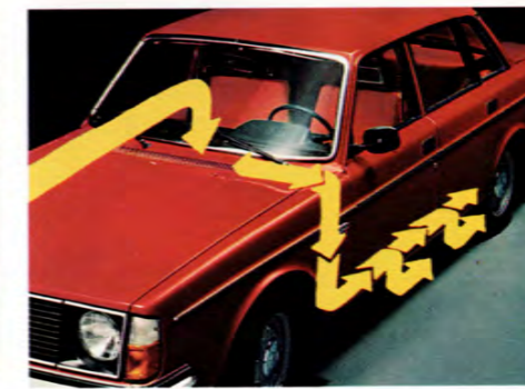
På bilar angrips dörrtrösklarna ofta av rost. Dörrtrösklarna på Volvo 244/245 är polyes- terbehandlade och genomluftas av fartvinden för att hållas torra.
