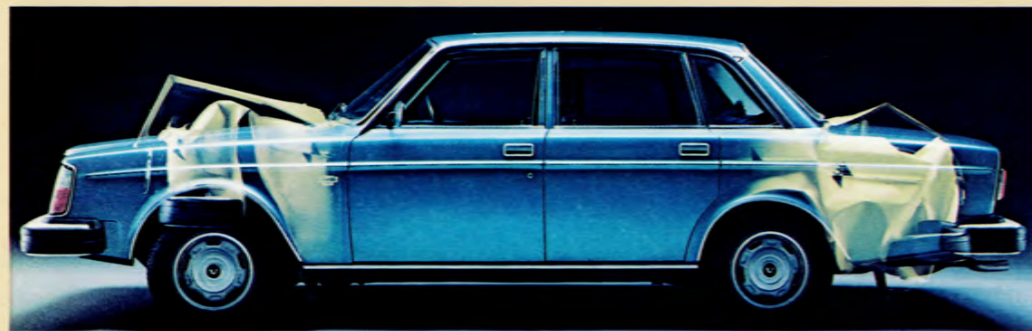
Volvo 264/265 har en kaross som är både mjuk och hård. Fram- och bakparti är mjuka, energiupptagande för att bromsa upp kraften vid en krock. Förare och passagerare är omgivna av en hård, skyddande säkerhetsbur. I dörrarna finns dessutom sidokrockskydd.
