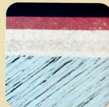
Den utomordentligt noggranna och omfattande lackeringsprocessen bidrar till att Volvo 260-serien har ett av världens bästa rostskydd. (Foto från ett mikroskop.)
