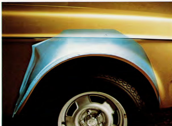
De främre hjulhusen har separata innerskärmar av slagkraftig polypropen som skydd mot stenskott. Det ger lägre ljudnivå och bättre korrosionsskydd.
