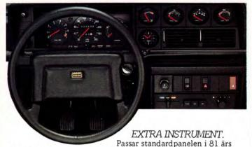
240/260-vagnar. Sortimentet omfattar varvräknare, oljetrycksmätare, oljetempmätare, vakuummeter, voltmeter, yttertempmätare och kvarts-ur. Uret monteras då standarduret ersatts med varvräknare. OBS! Oljetrycks- och oljetempmätare passar ej 260-vagnarna.
