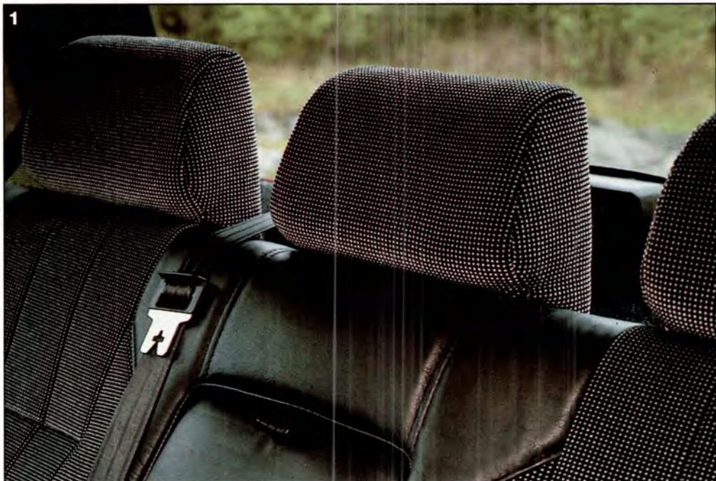
1. TREPUNKTS RULLBÄLTE, MITTEN BAK SAMT NACKSKYDD. Höjer ytterligare säkerheten för mittpassageraren bak. Dessa två utrustningsdetaljer, i kombination med bälteskudde gör platsen till bilens säkraste för barn mellan ca 4 och 10 år. Finns till Volvo 740 Sedan. Nackskydd, se sid 29.
