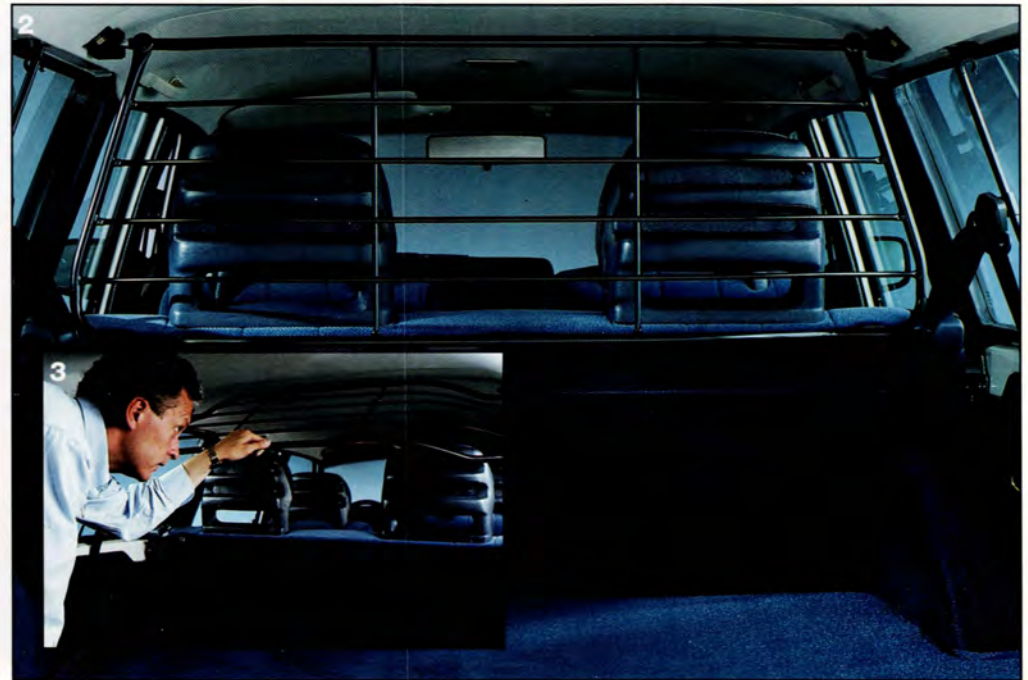
2, 3. SKYDDSGALLER. Hindrar djur eller last att kastas framåt vid en häftig inbromsning. Demonteras när bakåtvänt extrasäte används. Till Volvo Herrgårdsvagnar 960/940, 740 och 240. Kan kompletteras med komfortkudde för mittpassageraren, se sid 46.
