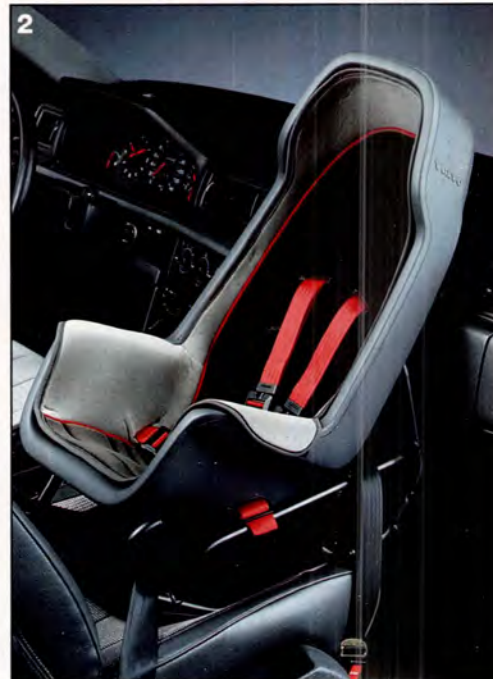
2. BARNSTOL FÖR BARN UPP TILL CA 4 ÅR. Stolen fixeras bakåtvänd med en monterings-sats, speciell för varje bilmodell, samt med hjälp av bilens ordinarie bilbälte. Barnet fixeras med 4-punktsbälte. Uppfyller Volvos hårda säkerhetskrav, såväl som de europeiska ECE-R44-kraven. Uppfyller även Volvos långtgående krav på brandhärdighet. Klädseln är maskintvättbar, 40°C.
