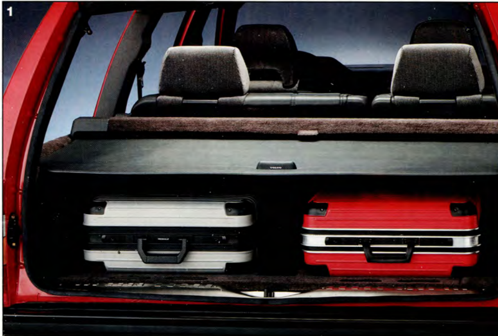
1. INSYNSSKYDD MED HATTHYLLA. Ena delen är fast, där du kan lägga småprylar. Andra delen dras ut över lasten och skyddar ditt bagage från insyn. Lätt att ta bort vid behov. Till Volvo Herrgårdsvagnar 960/940 och 740. Till Volvo 480 och 240 finns insynsskyddet utan hatthylla. 965/945/745 insynsskydd med hatthylla
