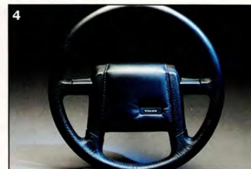
4. EXKLUSIV LÄDERRATT – GENUA. Läderratt av högsta kvalitet. Säkerhets- och krocktestad. Diam. 375 mm. Passar Volvo 940 och 740. Ratt- nav ingår.
