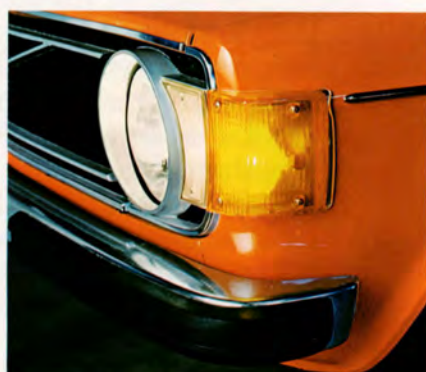
Den nya blinkerutformningen gör att ljusen syns bättre även från sidan – värdefullt när man t.ex. skall svänga ut på en väg och står vinkelrätt mot trafiken.
