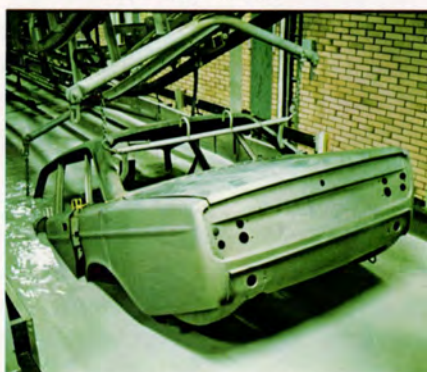
Även rotskyddet har förbättrats ytterligare. Genom elektrodoppning.
