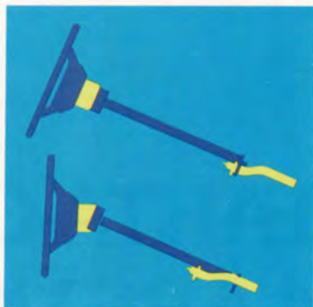
Genom madrasseringen i ratten och ett speciellt kollapsdon mellan rattstäng och ratt, har säkerhetsratten blivit ännu säkrare.
