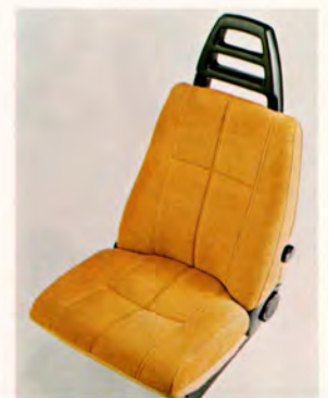
Volvostolen har även den, fått, nytt utförande. Stoppningen har blivit fastare än tidigare, stolen har blivit smalare och nackskyddet har fått ny utformning.
