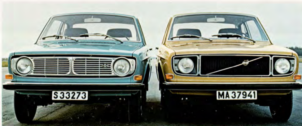
Frontplaten är varmgalvaniserad för att skydda mot t.ex. stenskott. Grillen har fått ny design på de Luxe- och Grand Luxe-modellerna.
