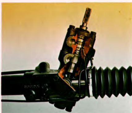
Kuggstångsstyrningen ger en mer exakt styrning vilket bidrar till både goda vägegenskaper, smidighet och följsamhet.
