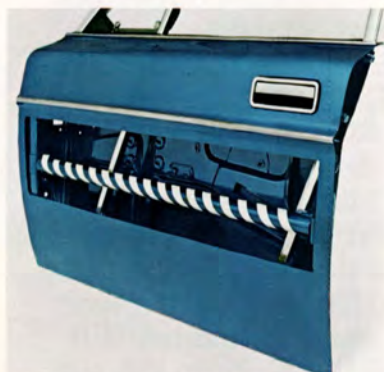
En viktig säkerhetsdetalj som inte syns är sidokrocksskyddet i dörrarna.
