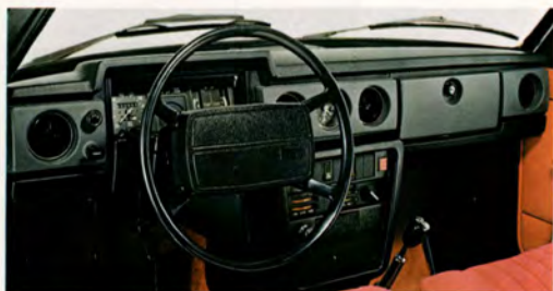
Den nya instrumentpanelen har fått säkrare och mer lättavläst utformning. Samtidigt har ventilationssystemet kunnat göras än mer effektivt.
