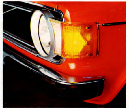
Den nya blinkerutformningen gör att ljusen syns bättre även från sidan — värdefullt när man t.ex. skall svänga ut på en väg och står vinkelrätt mot trafiken.
