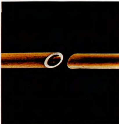
Nya bromsrör i korrosionsbeständig legering (87% koppar, 10% nickel och 3% järn/mangan).
