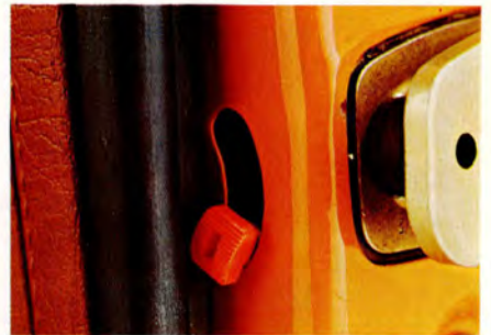
Nu behöver du inte vara orolig för ungarna längre, även om du har en fyradörrars bil. Alla modeller har nämligen barnsäkra lås i bakdörrarna.
