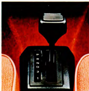
Även bilar med automatlåda har fått "golvväxel". Nu med sex lägen istället för, som tidigare, fem.
