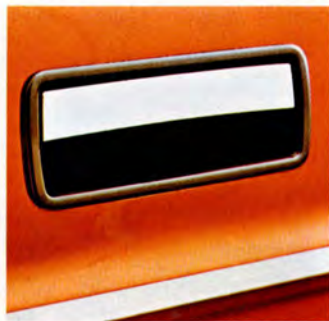
Den yttre skillnaden från tidigare årsmodeller är de säkrare, infällda dörrhandtagen.
