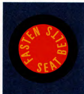
En varningslampa som talar om när du glömt ta på dig bilbältet (endast på modeller tillverkade efter 1/1-72).
