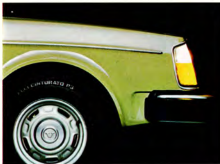
Det nya frampartiet på både 240-serien och 264 har en förlängd deformationszon som ökar energiupptagningen vid frontalkrockar. D.v.s. skyddar mer effektivt själva passagerarutrymmet.
