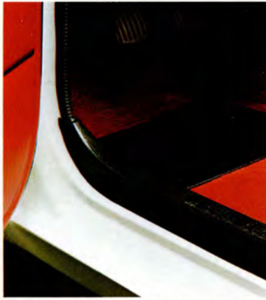
Dörrtröskelskydden av plast ger tröskeln ett ökat skydd i fram- och bakkant.
