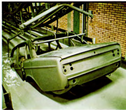
Även rostskyddet har förbättrats ytterligare. Genom elektrodoppning.
