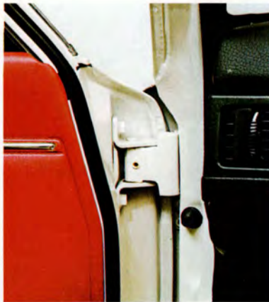
Dörrarna har fått kraftigare gångjärn som klarar större sidopåkänningar, ger distinktare öppningslägen och ger mindre risk för gnissel.
