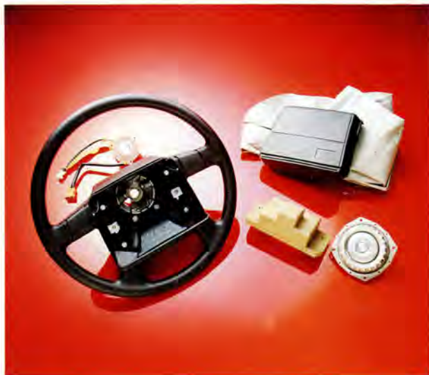
Den hopvikta kudden och gasgeneratorn är monterade i rattcentrum. Den fyrkantiga sensorn är placerad under stolen.
