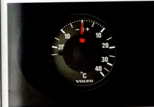
YTTERTEMPERATURMÄTARE. Mäter temperaturen strax ovanför vägbanan. En röd lysdiod visar när risken för frosthalka är särskilt stor.
