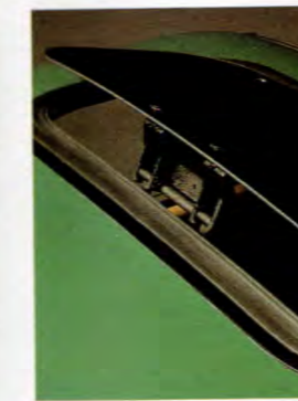
TAKLUCKA I GLAS. Öppnar taket och ger en behaglig ventilation. Glaset är folierat för effektivt skydd mot sol och solhettan. Släpper genom solstrålning.
