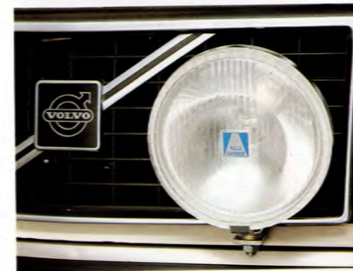
RUNDA EXTRALJUS. Dim- eller fjärrljus med 170, 186 eller 192 mm ljusöppning. Förpackade i par.
