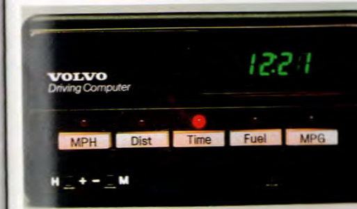
FÄRDDATOR. Ger värdefull information medan du kör: förbrukat bränsle i liter, aktuell förbrukning i liter/100 km, medelförbrukning i liter/100 km. Visar även tid.
