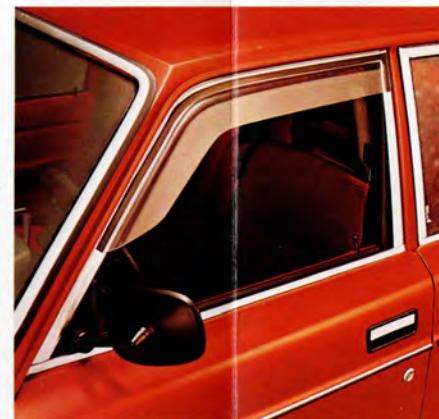
VINDAVVISARE FÖR SIDORUTAN. Minskar drag och vindbrus. Monteras utan ingrepp i karossen. Glasklar, färgtonad. Levereras i par.
