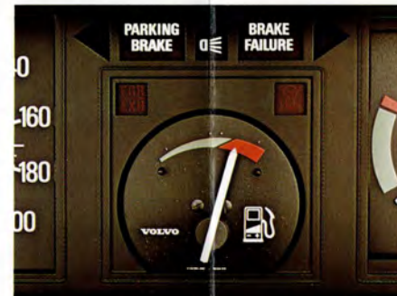
VACUUMMETER. Vacuummätare som varnar för oekonomisk körning.
