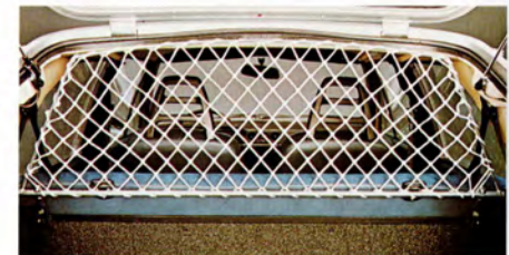
SKYDDSNÄT. Nylon fastspänd på kromade stålrör. Hindrar last att kastas fram vid hårda inbromsningar.
