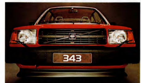
SPOILER. Ger 4 % mindre vindmotstånd. 2 % bättre sidvindsmotstånd och 16 % högre framaxeltryck. Splitterfri glasfiberförstärkt ABS-plast.
