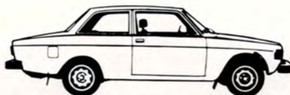
Volvo 142/144 Grand Luxe Motor: B 20 E med bränsleinsprutning av CI-typ - 124 hk DIN
