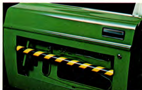
Rörförstärkning i dörrarna är en del av säkerhetskarossen. Skyddar de åkande vid påkörning från sidan.
