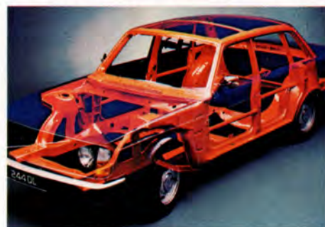
Säkerhetsbur av kraftiga stålprofiler med välberäknade deformationszoner fram och bak ger de åkande maximalt skydd vid en eventuell kollision.
