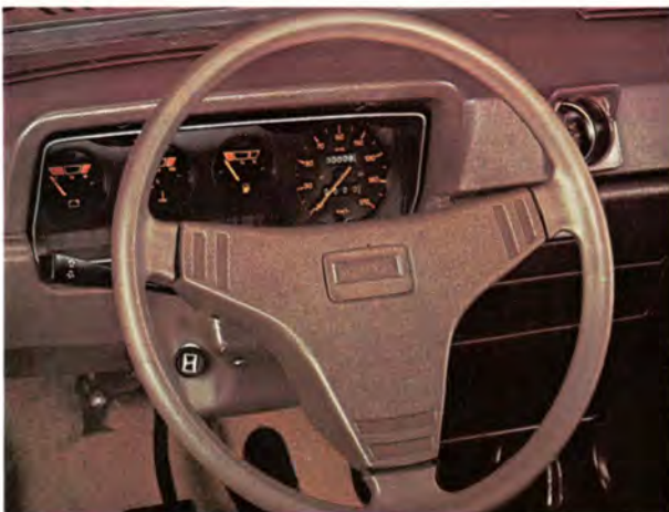
Instrumentpanelen har utformats för att underlätta så mycket som möjligt för föraren. Alla kontroll- och varningslampor finns samlade i en enda rad.
