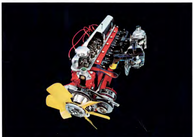
B30-motorn. Den här treliters sexan är den tysta och vibrationsfria kraftkällan i Volvos 164-modeller. Även den här motorn bygger på erfarenheterna av den berömda B20-motorn. Den finns i två utföranden. Dels B30A med dubbla förgasare och med en effekt på 96 kW (130 hk DIN) och dels med elektronisk direktinsprutning med effekten 118 kW (160 hk DIN).
