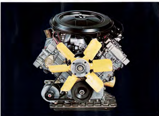
B27-motorn. B27-motorn är 260-seriens motor. Den är utvecklad i samarbete med Peugeot och Renault. Motorn är i lättmetall och är en sexcylindrig V-motor med överläggande kamaxlar. Den finns i två utföranden: Dels som förgasarmotor med effekten 92 kW (125 hk DIN) och dels med direktinsprutning med en effekt av 103 kW (140 hk DIN).
