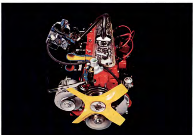
B20-motorn. B20-motorn är Volvos verkliga trojänare. Under årens lopp har den här motorn i sina olika varianter alltifrån B20A på 60 kW (82 hk DIN) till B20E på 91 kW (124 hk DIN), fått epitetet "världens slitstarkaste personbilmotor" och liknande.
