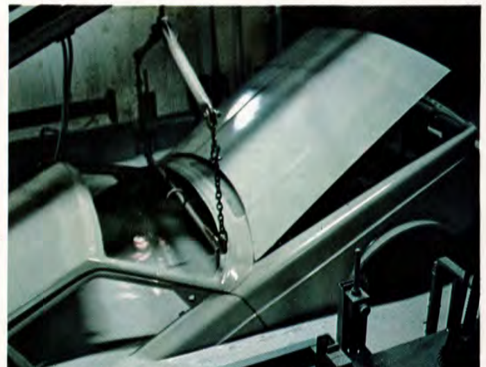
In einem sorgfältigen Lackierungsprozeß werden die vielfachen Lackschichten aufgetragen.
