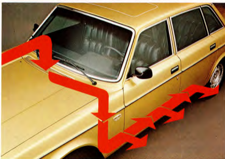
Optimal gegen Rost geschützt sind die polyesterbehandelten Türschwelle. Durchströmender Fahrtwind hält sie ständig trocken.
