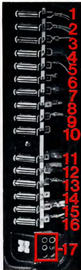
17 Hål för reservsäkringar
