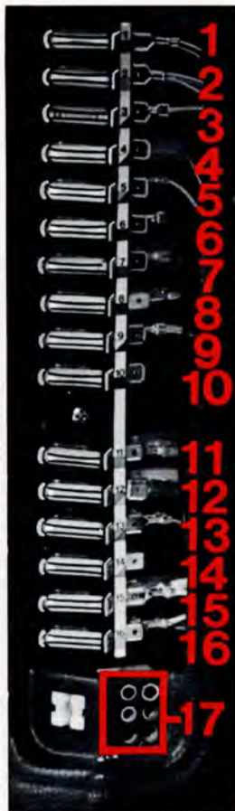
17 Hål för reservsäkringar
