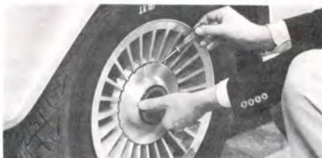
Ta bort hjulkapseln med skruvmejseln
