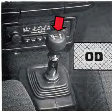
Överväxels strömställare och kontrollampa
