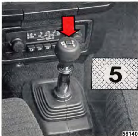
Överväxels strömställare och kontrollampa
