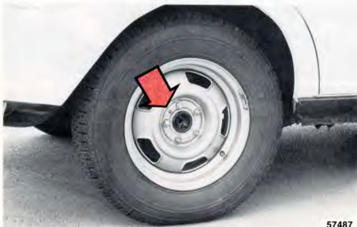
Styrtappen i det extra hålet på fälgen
