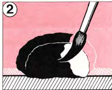
Lägg på grundfärg
