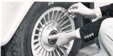
Ta bort hjulkapseln med skruvmejseln
