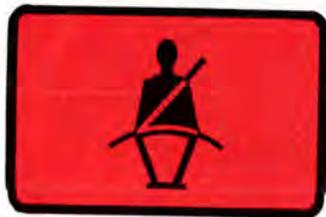
Wenn gefahren wird, ohne daß Fahrer oder Beifahrer sich angeschnallt haben, signalieren zwei Warnleuchten; die eine in der Mittelkonsole und die andere in der Verkleidung der Handbremssperre zwischen den Vordersitzen.
