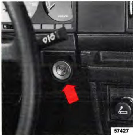
Fahrnlaßschalter mit Lenkschloß
