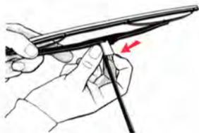
Wischerarm nach vorn schwenken, dann das Wischerblatt quer zum Wischerarm stellen. Die Klemmfeder auf der Unterseite des Wischerarms durchdrücken.
