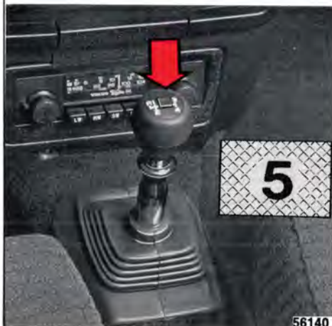
Överväxelns strömställare och kontrollampa
