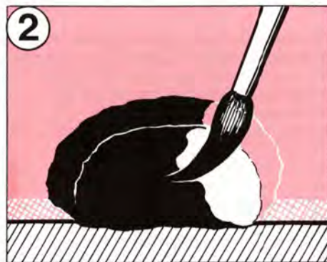
Lägg på grundfärg
