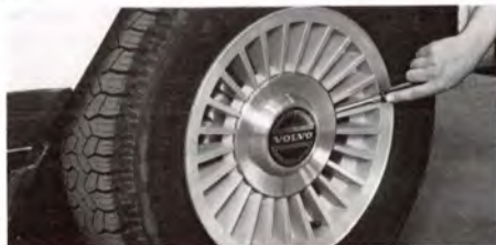
Ta bort hjulkapseln med skruvmejseln
