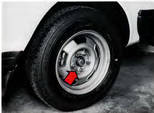
Styr tappen i det extra hålet på fälgen
