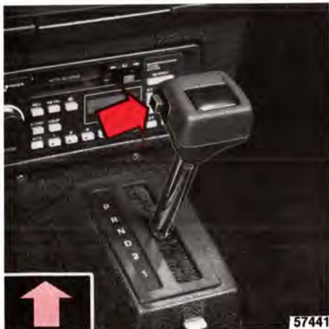
Strömställare och kontrollampa för ur-/inkoppling av 4:ans växel
