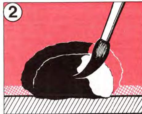
Lägg på grundfärg
