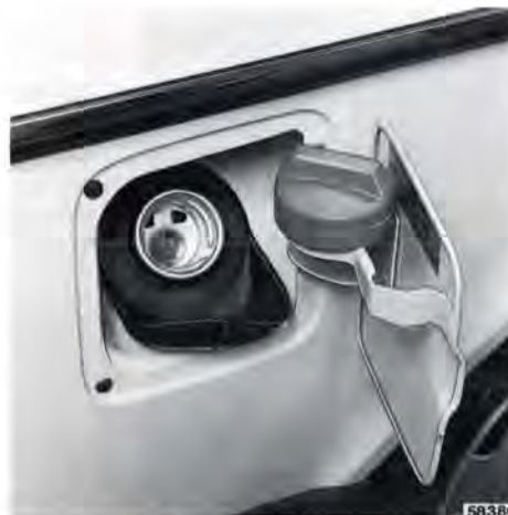
Tankrör med strypning på bil med katalysator
