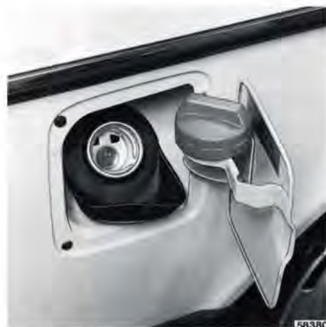
Påfyllningsrör med strypning på bil med katalysator
