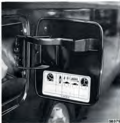
På tankluckans insida finns en däcktrycksdekal som anger rätt luftryck i däckerna
