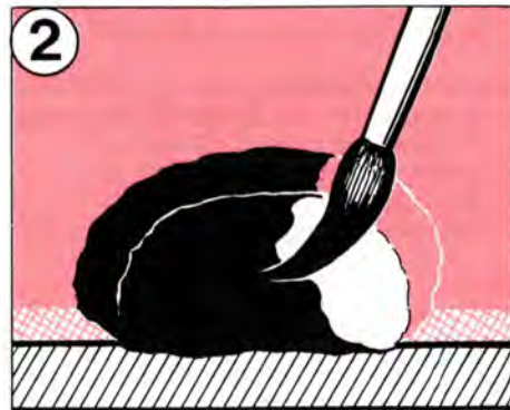
Lägg på grundfärg
