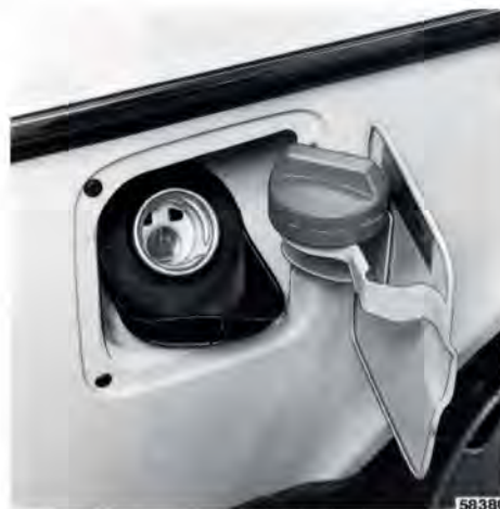
Påfyllningsrör med strypning på bil med katalysator
