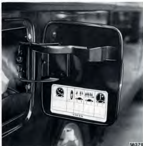
På tankluckans insida finns en däcktrycksdekal som anger rätt luftryck i däcken
