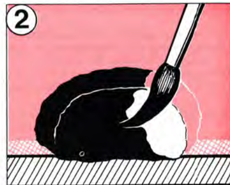
Lägg på grundfärg
