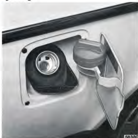
Påfyllningsrör med strypning på bil med katalysator
