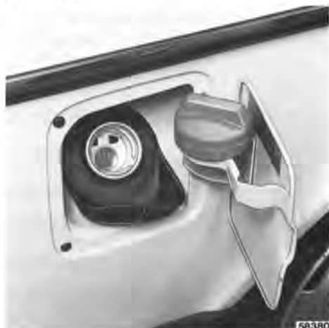
Påfyllningsrör med strypning på bil med katalysator
