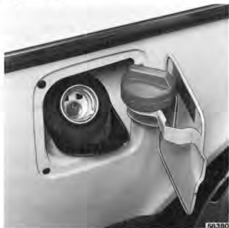
Påfyllningsrör med strypning på bil med katalysator
