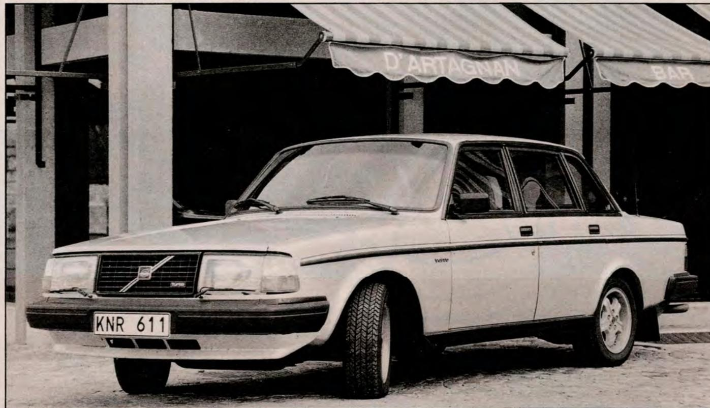
Kleinere Stoßstangen, größere Scheinwerfer beim Volvo 244 Turbo
