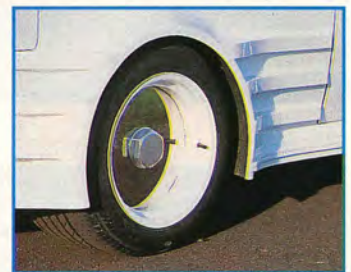
Bakre hjulhusen har breddats 9 cm per sida. Breddade plåtfälgar från Volvo.
