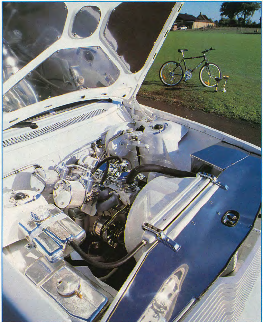
Eilar har experimenterat med sprutspackel på motorblocket. Expansionskärl och spolarvätskebehållaren är plastkromade. Huvens insida och den övre/inre frontplåten samt batteriet har kläts med rostfria plåtar. Grill av egen tillverkning.
