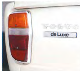
Grill och lychtsarger är tillverkade i aluminium.
