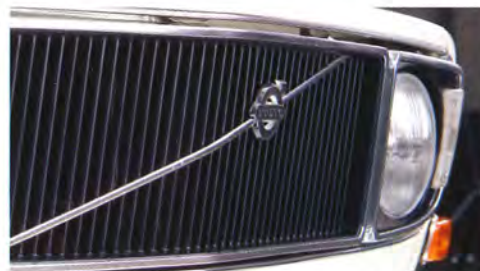
Grill och lychtsarger är tillverkade i aluminium.
