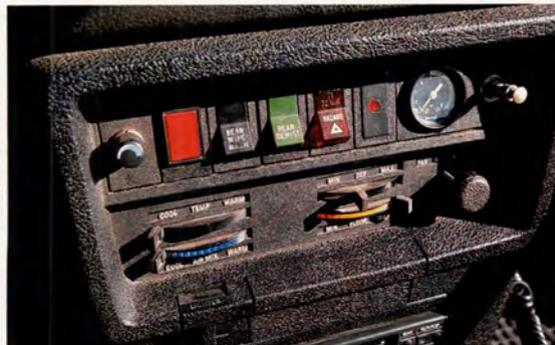
Eine Mittelkonsole, funktional wie eine Einbauküche. Das nachgerüstete Manometer überwacht den Niveaulift
