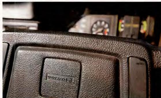
Späteres GL-Lenkrad mit Prallplatte, Drehzahlmesser als Extra. Die Zahnstangenlenkung verzichtet auf Servohilfe
