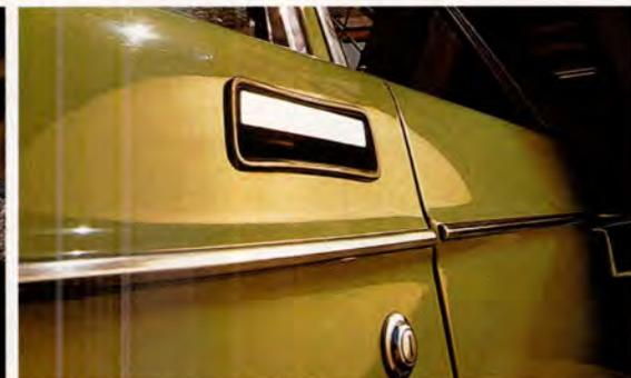
In den dicken Geldschranktüren mit Sicherheitsgriffen stecken Stahlrohre als Seitenaufprallschutz
