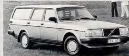
dem hinter der A-Säule immer noch ein 145 - bis auf den neuen OHC-Querstrommotor, die neue McPherson-Vorderachse und die neu gestaltete Frontpartie nach dem Vorbild der Volvo-Sicherheitsstudie VESC von 1972. Diese modern gestaltete Karosserie sollte ursprünglich die 140er-Baureihe radikal ersetzen. Doch Engellau entschied sich vehement dagegen: „Zu früh, zu gewagt, zu teuer!“
